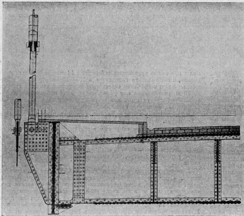
Стальная клепанная цепь очерчена по веревочной кривой, от постоянной нагрузки, стрелка кривой  $= 1:8,85$  длины пролета. Сечение цепи  $\pi$ -образное, по средине переходит в две вертикальные стенки у опор, необходимые для соединения цепи с шарнирами, цепь среднего пролета соединена с цепями крайних посредством железных клепанных тяжей, проходящих внутри железобетонных рам.
