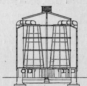
для стен всего отделения. Жел.-бет. перекрытие на уровне верха башен рассмотрено как балка, имеющая опорами торцевые кирпичные стены, воспринимающая на себя весь ветер. Из башни Гловера газ последовательно проходит через 8 камер, орошаемых снаружи водой. Оставить камеры на открытом воздухе, как это делали на Западе, в нашем климате, в виду  $t^{\circ}$  зимой, при которой остановился бы процесс, невозможно, почему камеры
